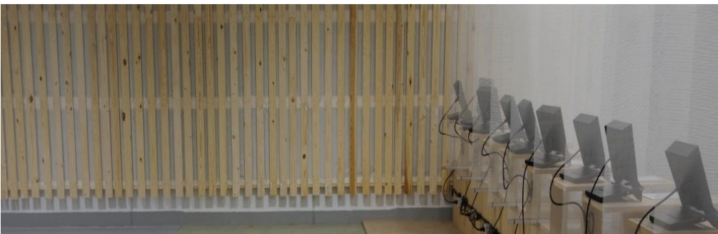
Bild 7:5. Träpalissad som tryckabsorberande och rikoschettskyddande material.
